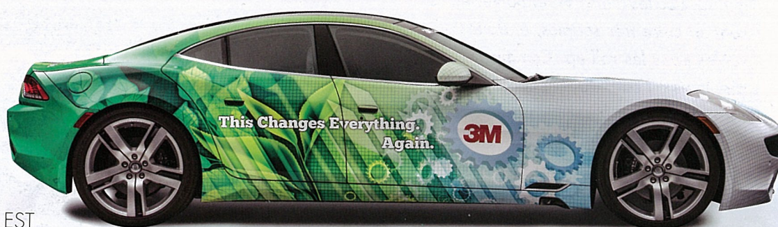
« Habillage » Envision 480 CV3 de 3M, film d'impression teinté conformable, sans PVC, imprimable en latex.
